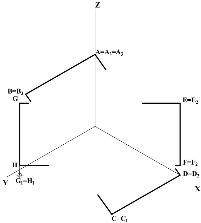
**B4.-** Completar la representación de la figura, que corresponde a una pieza doblemente simétrica con un corte a un cuarto, añadiendo, sin seccionar, la parte que falta a la izquierda. Acótese según normativa para su correcta definición dimensional.
